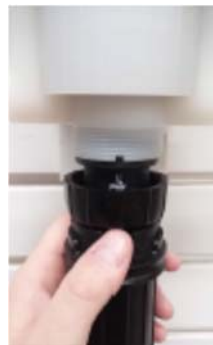
Krok 9. Załóż dolny koniec i pokrywę na korpus pompy. Upewnij się, że o-ring jest nadal w pokrywie przed ponownym założeniem.
