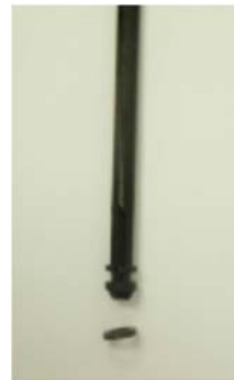
Krok 3. Usuń wałek z uszczelką i zainstaluj nowy. Jeśli doszło do uszkodzenia powierzchni uszczelniającej wału, wymień wał.
