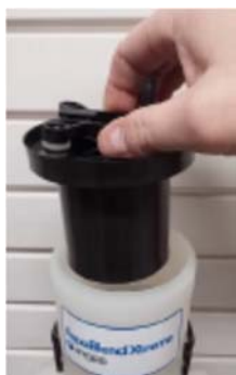
Krok 5. Usuń tłok silnika z korpusu pompy.
