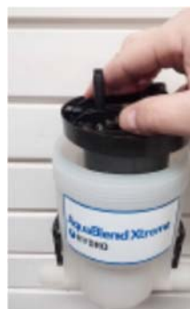
Krok 6. Umieść ostrożnie nowy tłok silnika w korpusie pompy i wymień pokrywę.
