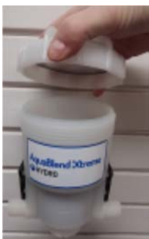
Krok 4. Przytrzymaj mocno korpus i odkręć wieko. Jeśli pokrywa jest szczelna, użyj luźnego gniazda 25 mm.
